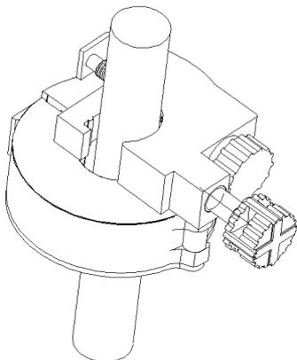
第四步：闭合互感器放下压线挡板，**将线缆紧靠刺针孔处，旋转螺杆收紧线缆**（如上图）
