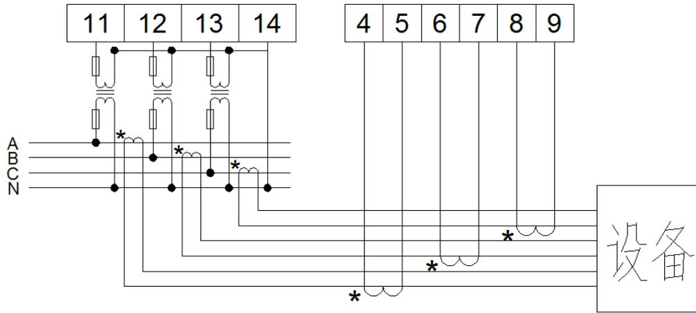
三相四线(电压、电流经互感器接入)
