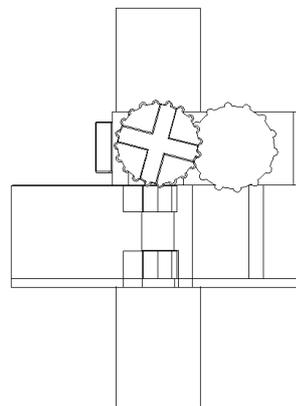
第五步：**旋转刺针螺杆，拧紧后将螺杆调整  $90^\circ < \text{十字印} < 150^\circ$** （如上图）
