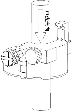
第三步：根据应用现场实际电流流向，正确安装互感器（如上图电流流向自上而下）。
