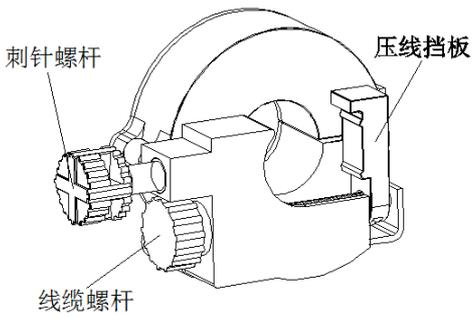
第一步：将刺针螺杆松到底，旋转线缆螺杆将压线挡板松到顶部（如上图）。
